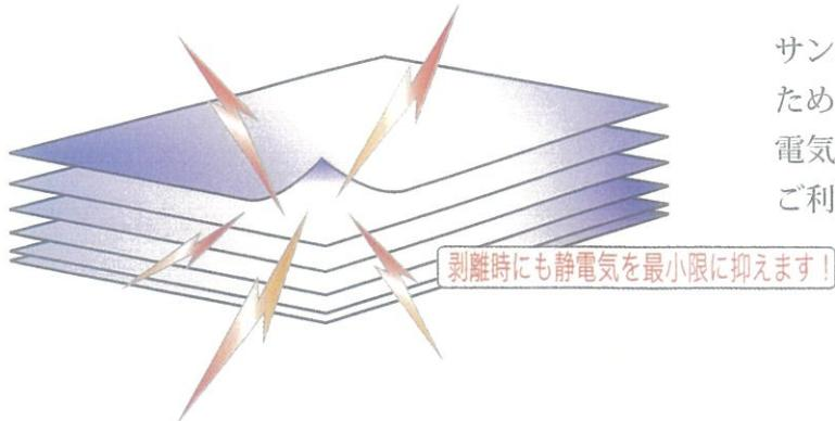
サンエー化研独自の特殊帯電防止処理を施しているため、フィルムを剥がす時に様々な影響を及ぼす静電気の発生を最小限に抑え、四季を通じて安心してご利用いただけます。
